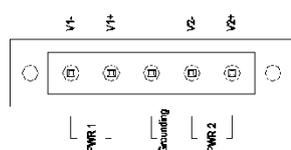
5-контактный разъем 5,08мм
